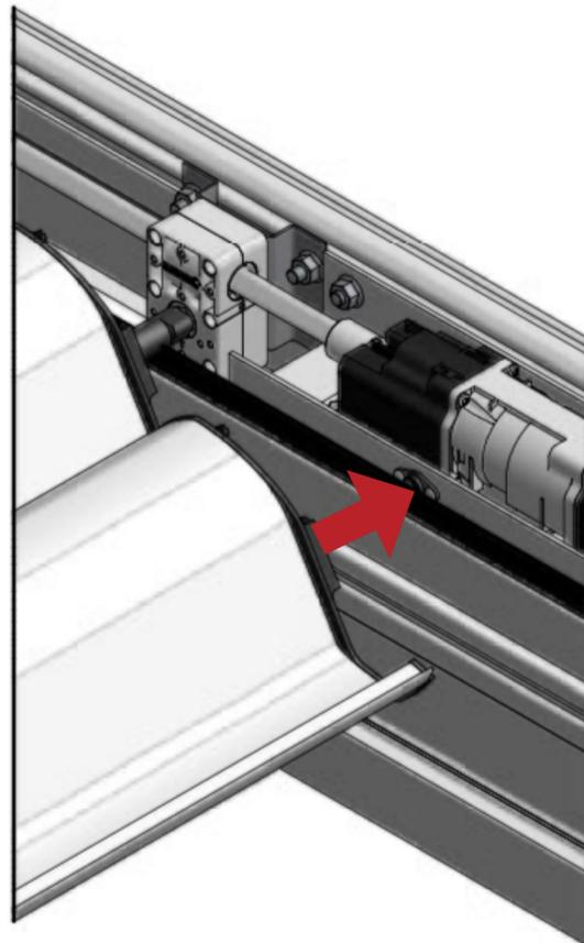
**3** GEGENÜBERLIEGENDE SEITE. Die Lamellen in die Achsen einführen. Sichern, indem Sie eine Sicherheitsschraube anbringen.
