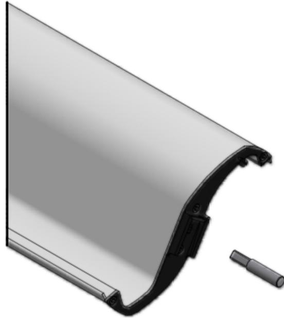
**2** MOTORSEITE. Die Achse in das Lager einführen
