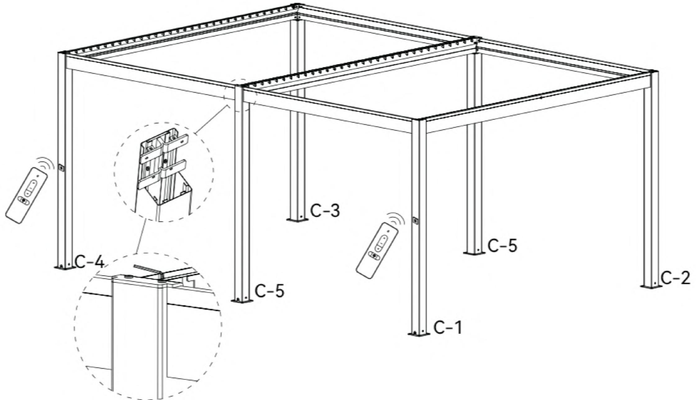
**4** Befestigen Sie die aufrechte Abdeckung 4x4 und befestigen Sie sie mit den Schrauben 6x8
