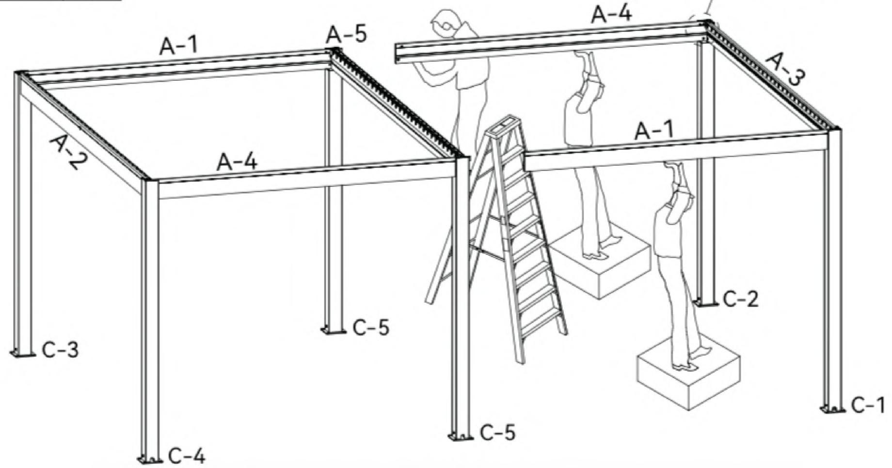
**3** Verwenden Sie zur Befestigung von Balken 1 und Balken 4 die Schrauben 6x4.
